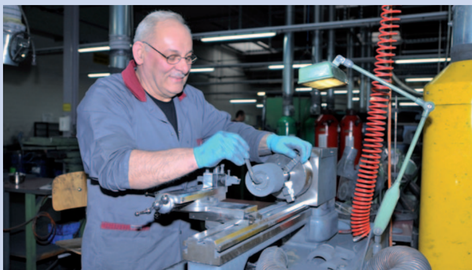
Voor het sinteren kunnen voorgevormde hardmetalen delen via mechanische bewerkingen als draaien en frezen een gewenste vorm krijgen
